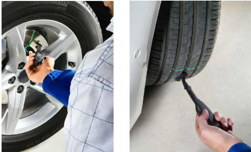
Fig. 2: Utilizzazione di LASER EXAMINER nella misurazione del profilo di dischi (sinistra) e battistrada (destra)
